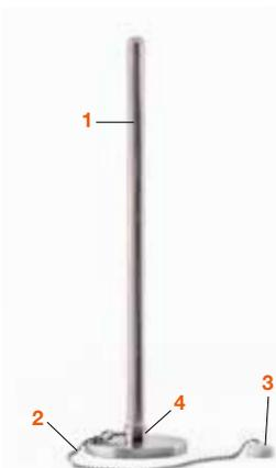
Die Prüfvorrichtung wird, wie in den Abbildungen oben dargestellt, im Einsitzbereich der Rutsche, 200 mm vom Übergang Einsitzteil/Rutschteil entfernt aufgestellt und der Knebel und die Kette werden zufällig unter Einwirkung ihres eigenen Gewichts ohne zusätzliche Krafteinwirkung an alle erreichbaren Stellen platziert. Bleibt der Knebel hängen, wird mit einer Kraft von ca. 5 kg in Richtung der erzwungenen Bewegung gezogen. Löst sich der Knebel, würde diese Stelle des Gerätes die Prüfung bestehen.
